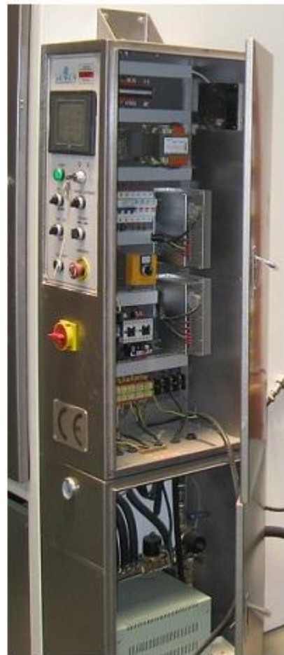
Основные узлы и агрегаты станка для пескоструйной обработки плоского стекла SKS-2500.
