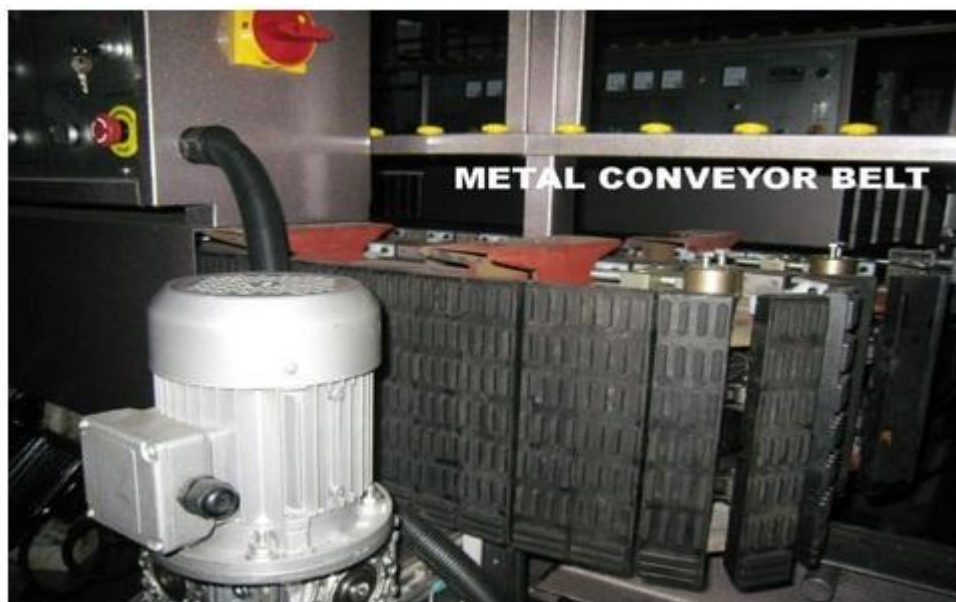
Конвейер изготовлен из металла с прорезиненным накладками, увеличивает срок службы конвейера и исключает вибрацию заготовки.
