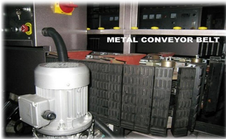
Конвейер изготовлен из металла с прорезиненным накладками, увеличивает срок службы конвейера и исключает вибрацию заготовки.
