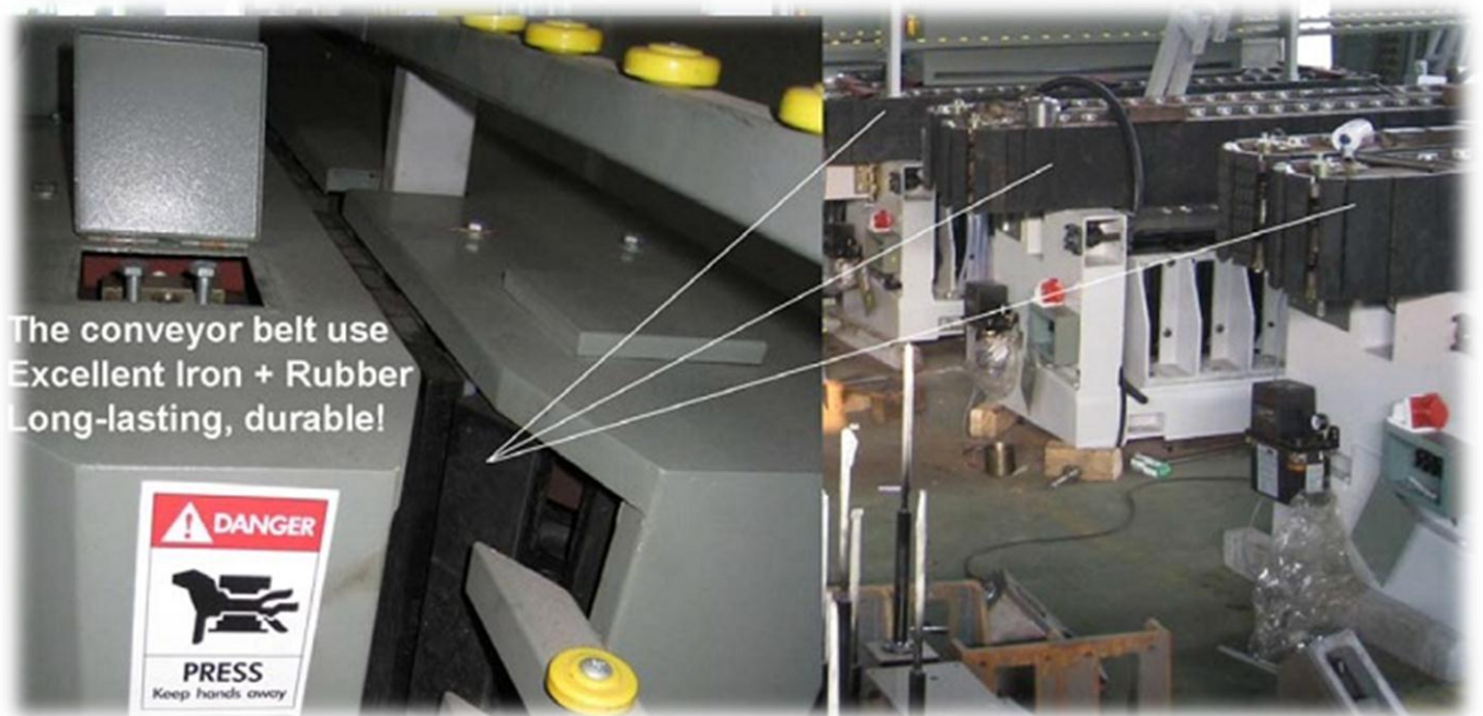
Конвейер изготовлен из металла с прорезиненным накладками, увеличивает срок службы конвейера и исключает вибрацию заготовки.
